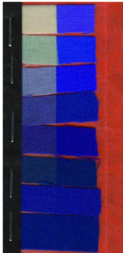
Figuur 7. ISO Blauwe wol standaard: acht stalen wol blootgesteld aan 120 Mlx.h (UV-rijk). Het kleurverschil tussen de belichte linker- en onbelichte rechterkant loopt van ISO 1 \Delta E = 45 (boven, 30 jwv: totaal verbleekt) via ISO 4 \Delta E = 15 (10 jwv) tot ISO 8 \Delta E = 1,5 (onder, 1 jwv).
